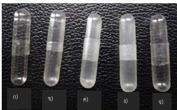
ภาพที่ 5 เปลือกแคปซูลจากสารแขวนลอยไฮดรอกซีโพรพิล เมทิลเซลลูโลสผสมสตาร์ชไฮดรอกซีโพรพิลิต ก) 100:0 ข) 70:30 ค) 50:50 ง) 30:70 และ จ) 0:100
